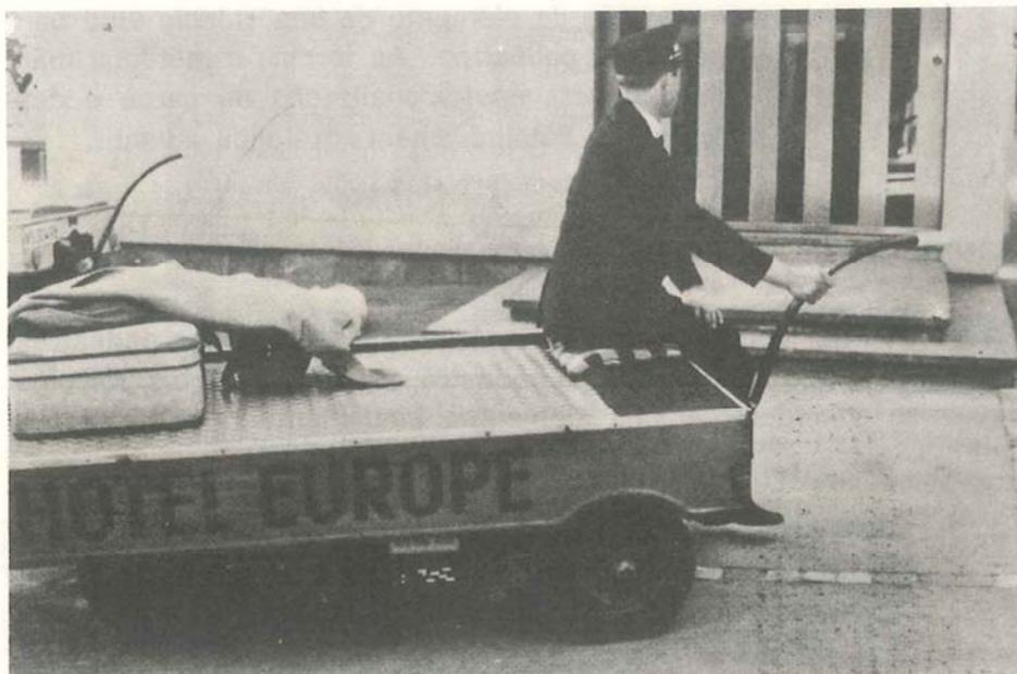
F.GS. 32 e 33 — VEÍCULOS ELÉTRICOS, ESPECIALMENTE PROJETADOS PARA O TRANSPORTE DE BAGAGENS NAS ÁREAS DE PEDESTRES DE ZERMATT.
